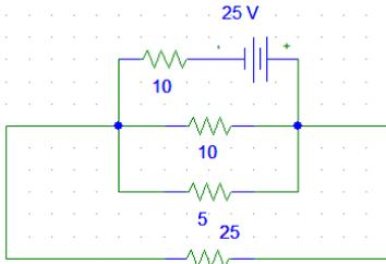
Encontramos el circuito equivalente del sistema. El voltaje  $V_{ab}$  es el mismo que existe en la resistencia de  $10\ \Omega$  que se encuentra debajo de la fuente y encima de la resistencia de  $5\ \Omega$ . La resistencia de  $5\ \Omega$  de más hacia la izquierda está en serie con la resistencia de  $20\ \Omega$ , de manera que la suma algebraica de estas dos resistencias es la resistencia equivalente.
