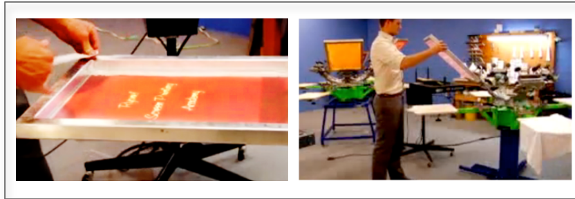
Gráfico 3.57 Preparación del bastidor en el pulpo.
