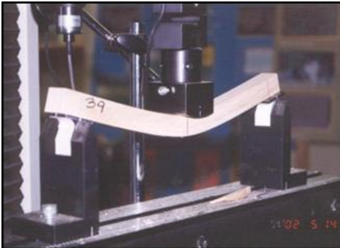
Figura N° 2: Esquema y ensayo de flexión estática en 3 puntos en máquina universal.
