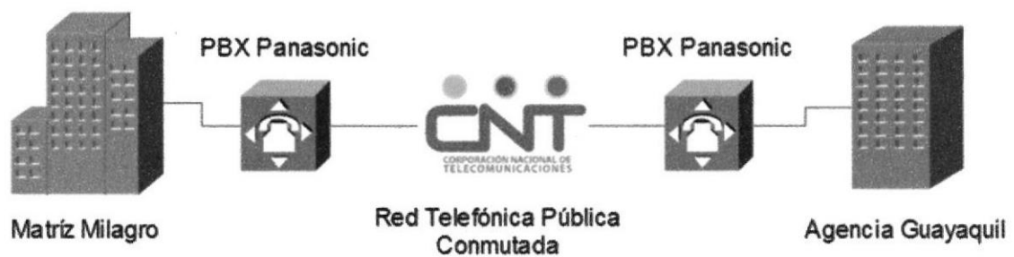
Gráfico 02.- Conexión actual de las centrales telefónicas.
