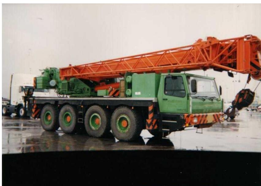
**FIGURA 5.1 . GRUA HIDRAULICA DE 60 TON DE CAPACIDAD**
