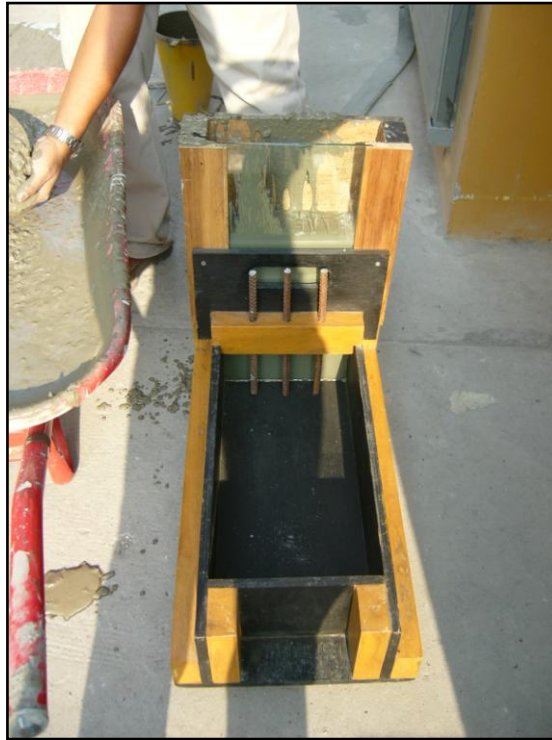
FOTO 29. ENSAYO CAJA L
