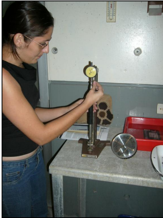
FOTO 23. DEFORMIMETRO PARA MEDIR RETRACCIONES
