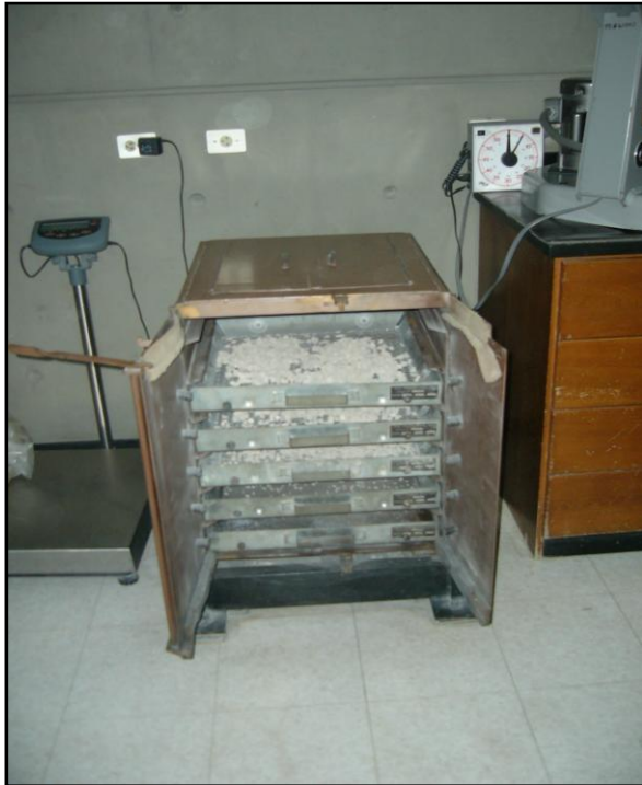
FOTO 1. TAMIZADO DE AGREGADO GRUESO
