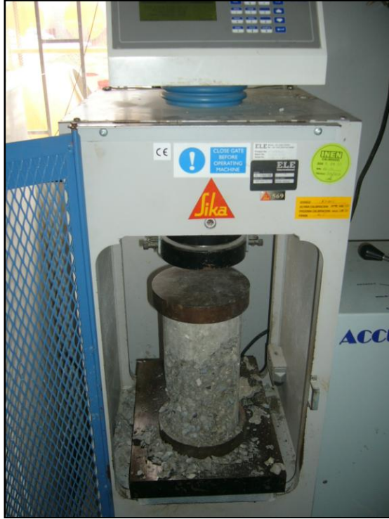
FOTO 31. ENSAYO A LA COMPRESION
