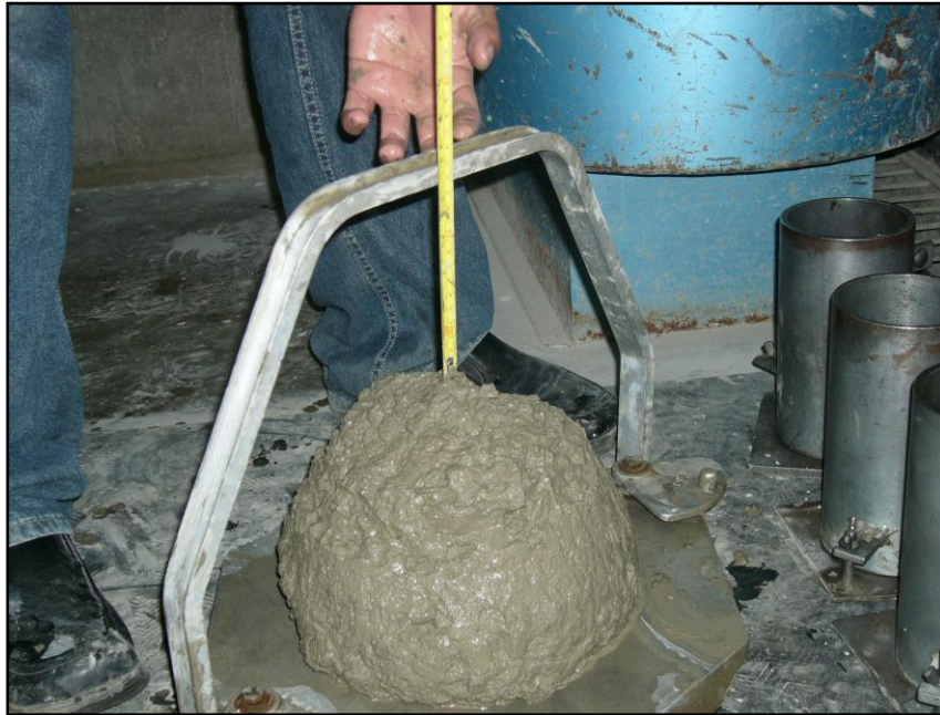
FOTO 17. CONTROL DEL ASENTAMIENTO
