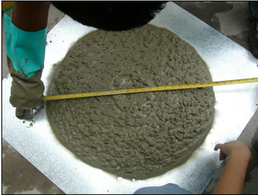
FOTO 27. MEDICION DEL FLUJO LIBRE (MUESTRA 1)
