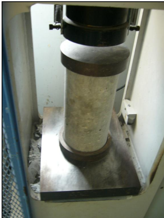
FOTO 22. ENSAYO A LA COMPRESION
