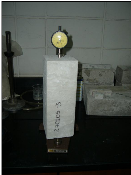
FOTO 24. ENSAYO DE RETRACCION DE VIGAS
