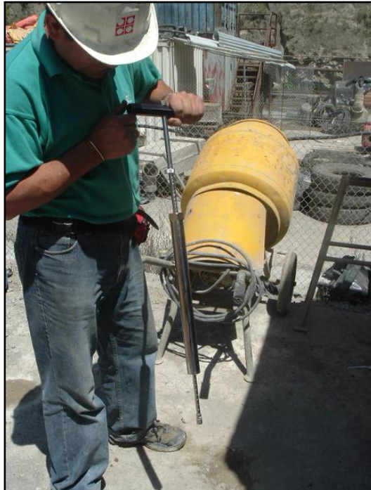
FOTO 13. PENETROMETRO PARA MEDICION DE FRAGUADO
