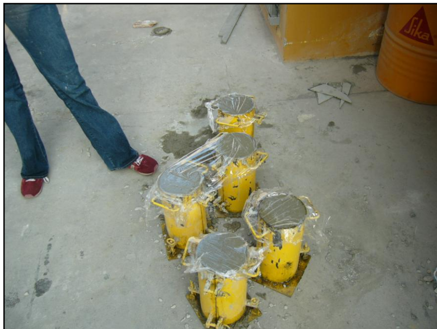
FOTO 30. TOMA DE CILINDROS
