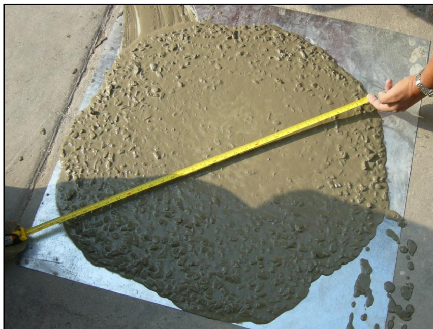
FOTO 28. MEDICION DEL FLUJO LIBRE (MUESTRA 2)
