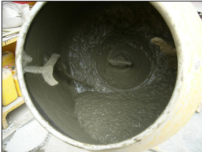
FOTO 26. MEZCLA INCORPORADO ADITIVO
