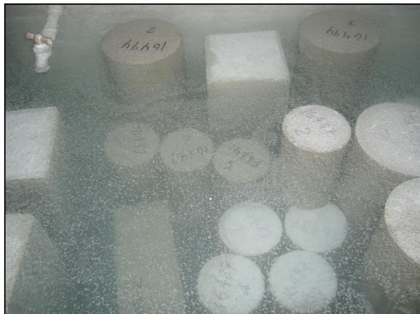
FOTO 20. CURADO DE CILINDROS Y VIGAS
