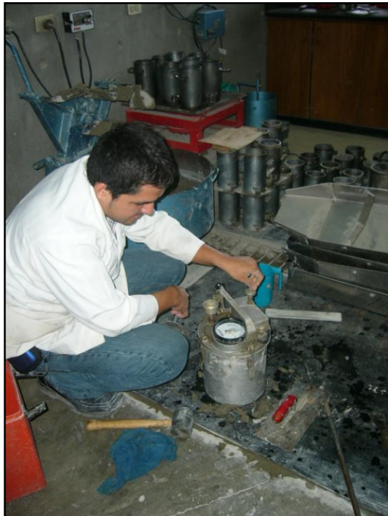
FOTO 18. MEDICION DEL CONTENIDO DE AIRE
