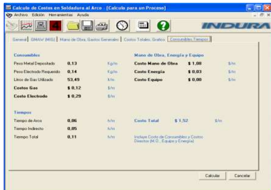
FIGURA 3.36: Cálculo de Costos de Soldadura 100% CO 2 (Corto Circuito)
