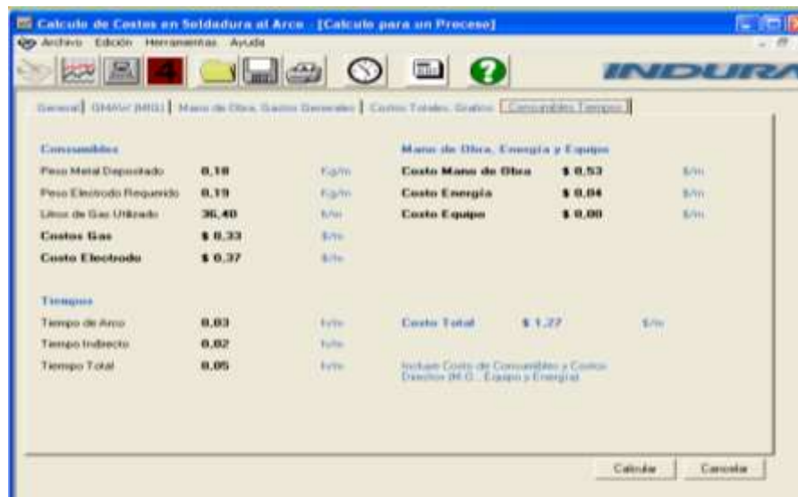
FIGURA 3.50: Cálculo de Costos de Soldadura 92% Ar + 8% CO 2 (Spray)
