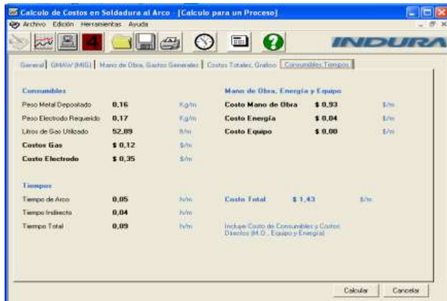
FIGURA 3.42: Cálculo de Costos de Soldadura 100% CO 2 (Globular)
