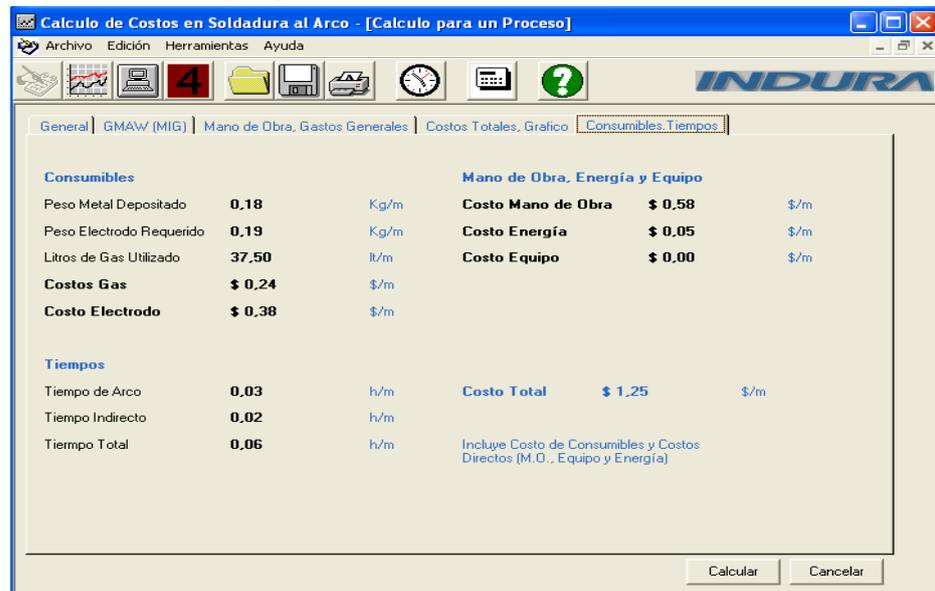
FIGURA 3.48: Cálculo de Costos de Soldadura 80% Ar + 20% CO<sub>2</sub> (Spray)
