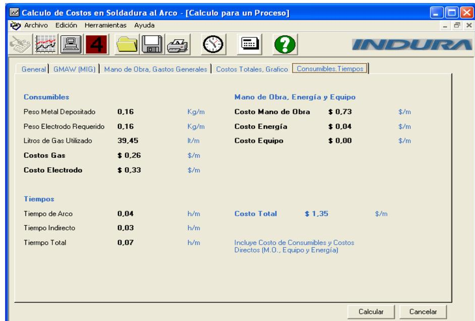
FIGURA 3.44: Cálculo de Costos de Soldadura 80% Ar + 20% CO<sub>2</sub> (Globular)
