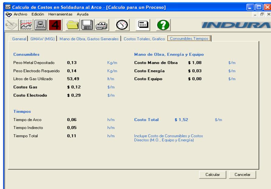
FIGURA 3.36: Cálculo de Costos de Soldadura 100% CO<sub>2</sub> (Corto Circuito)
