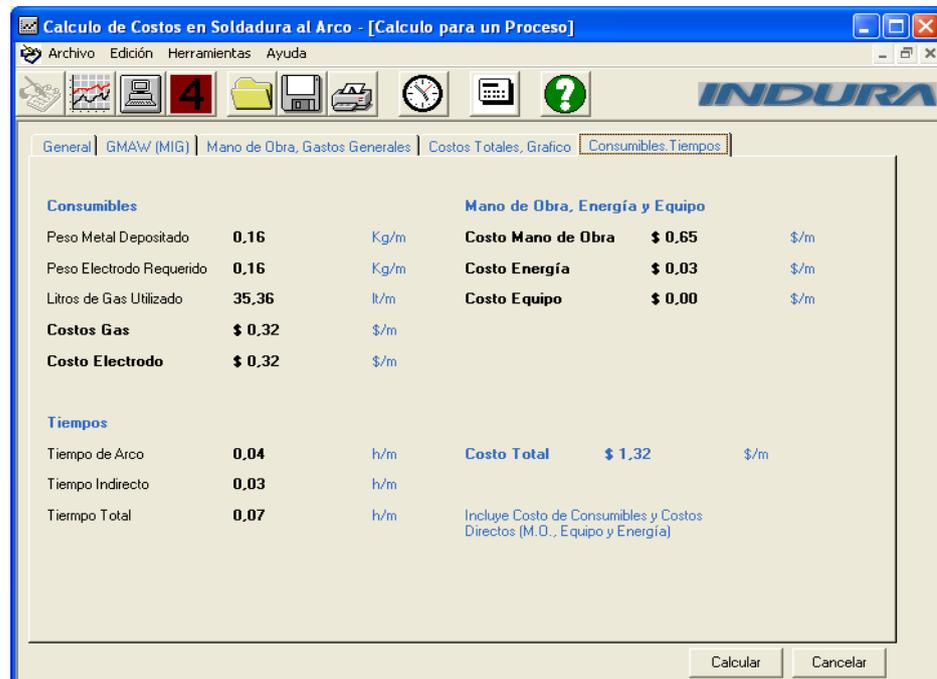
FIGURA 3.46: Cálculo de Costos de Soldadura 92% Ar + 8% CO<sub>2</sub> (Globular)
