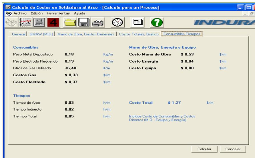
FIGURA 3.50: Cálculo de Costos de Soldadura 92% Ar + 8% CO<sub>2</sub> (Spray)
