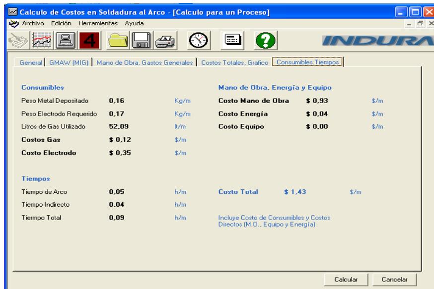
FIGURA 3.42: Cálculo de Costos de Soldadura 100% CO<sub>2</sub> (Globular)
