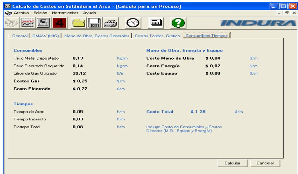
FIGURA 3.38: Cálculo de Costos de Soldadura 80% Ar + 20% CO<sub>2</sub> (Corto Circuito)
