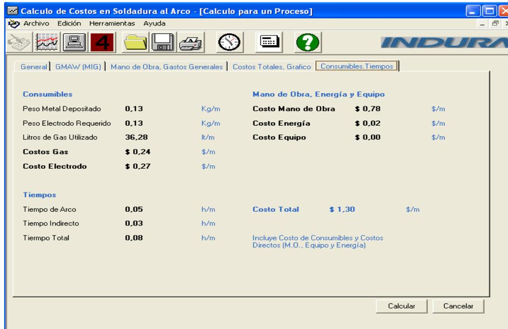
FIGURA 3.40: Cálculo de Costos de Soldadura 92% Ar + 8% CO<sub>2</sub> (Corto Circuito)
