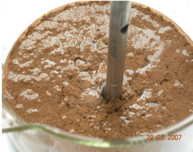
Fig. 4.11 Muestra de lodo coagulado y floculado, Cristina Ballesteros, abr/ 07
