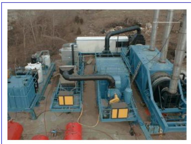
Fig.3.11 Planta de Tratamiento Térmico Indirecto, fuente: Presentación "Waste Management" de Brandt, proporcionado en octubre del 2006
