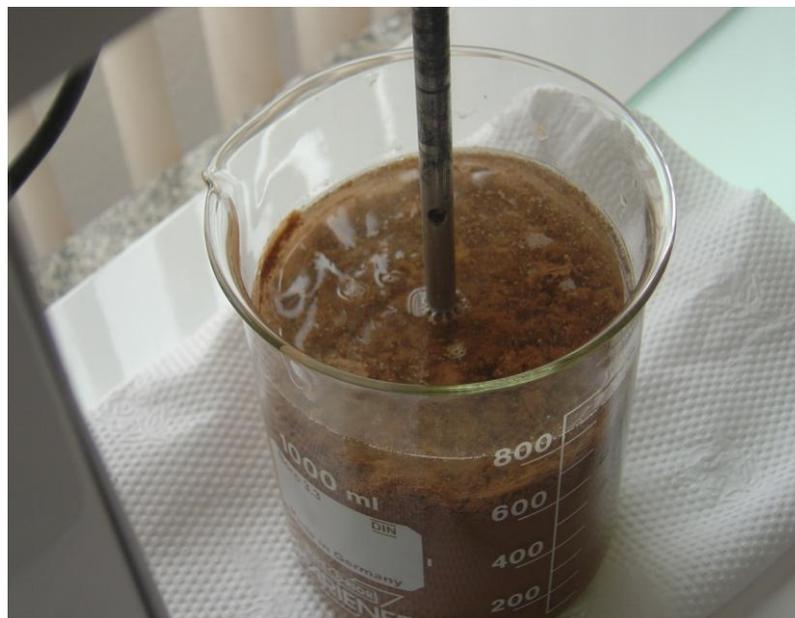
Fig. 4.12 Muestra de lodo con los flóculos sedimentados, Cristina Ballesteros, abr/ 07
