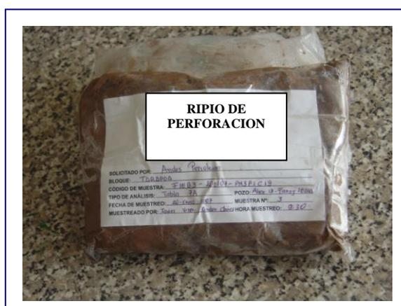
Fig. 2.3 . Funda de Ripio de Perforación; Cristina Ballesteros, Abril 2007.
