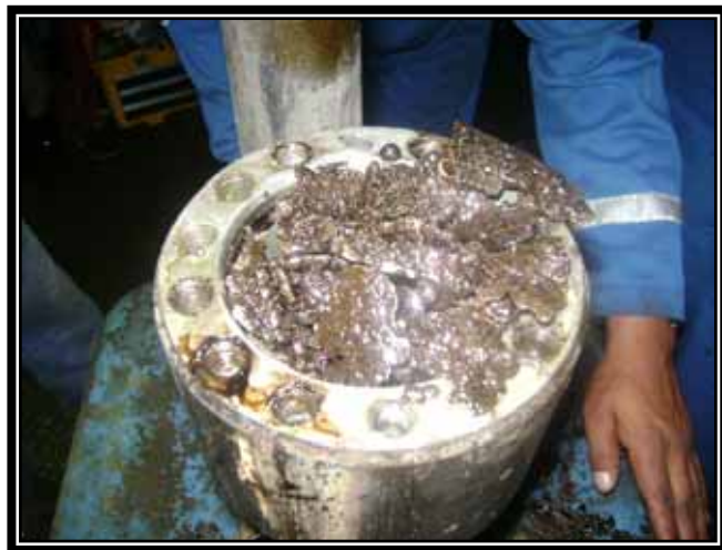
Figura 2.6 Incrustación de Carbonato de Calcio en el interior de una bomba
