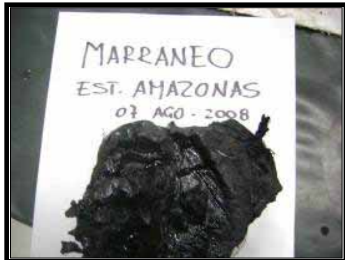
Figura 2.15 Muestra de Asfalteno obtenida del Marraneo
