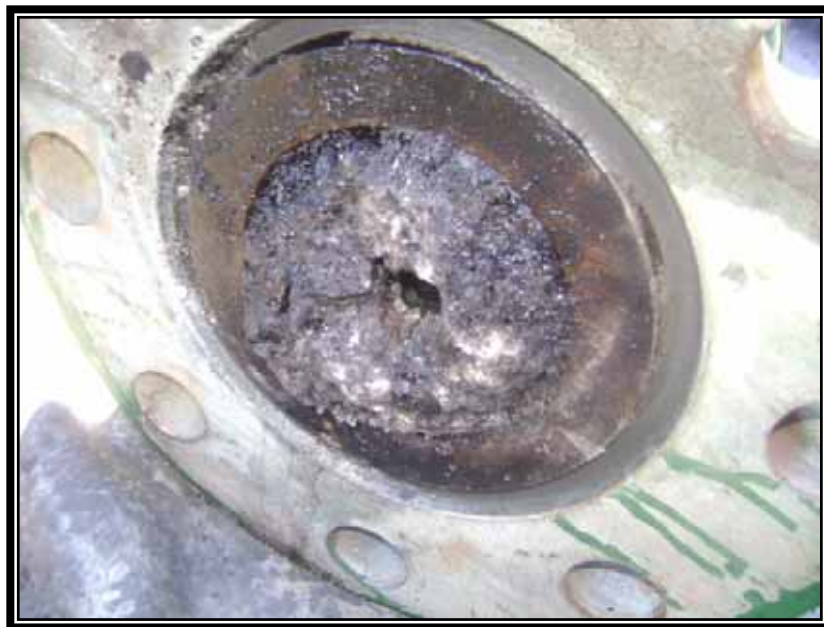
Figura 2.5 Escala en la Línea de Flujo de un Pozo
