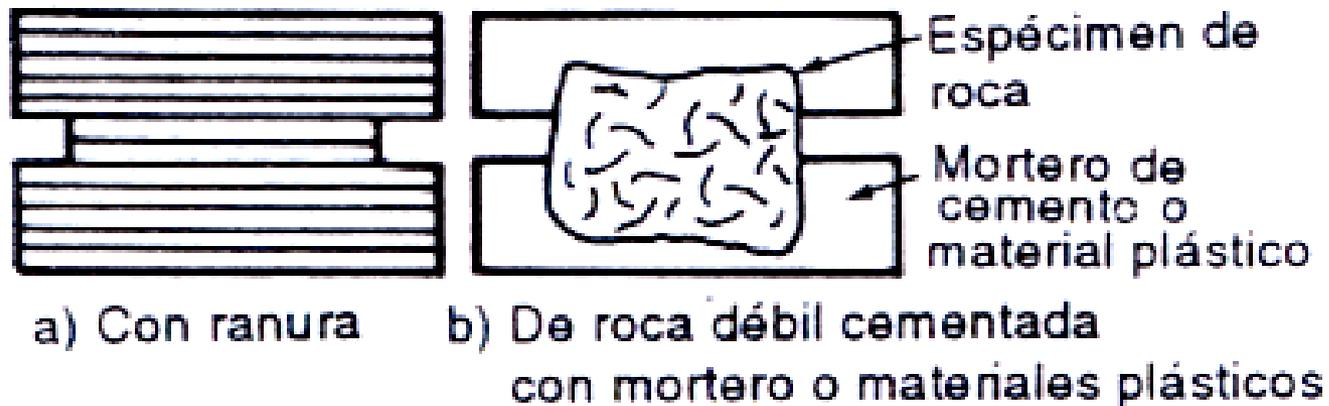
**Figura 6.16.** Especímenes de roca en un ensaye de corte simple. (Jaeger.)
