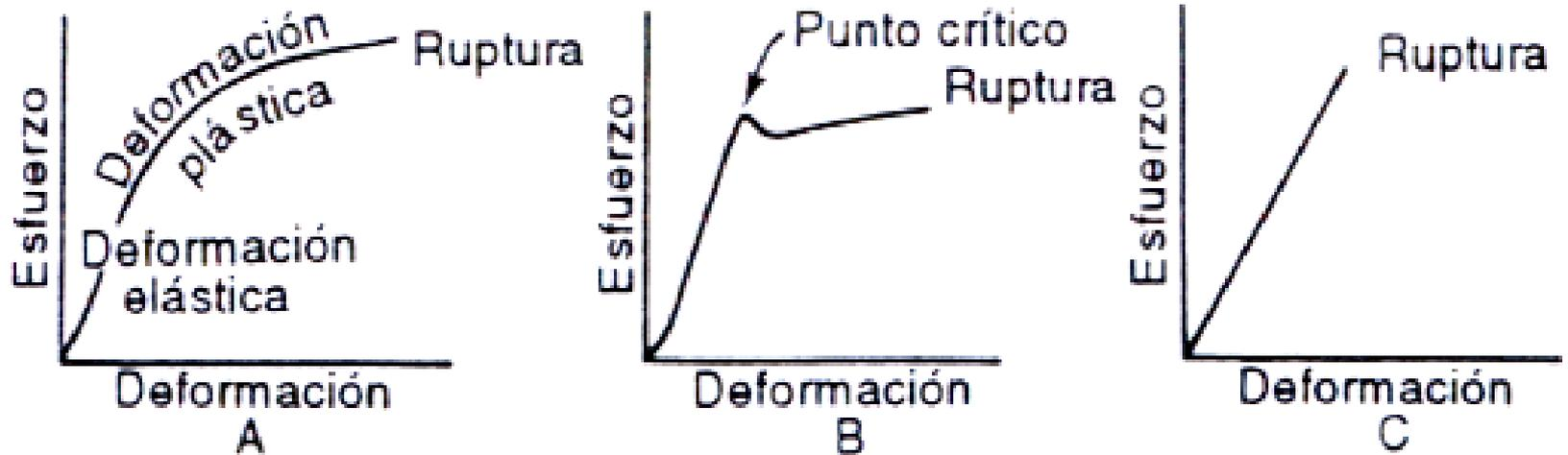
En cada caso la curva termina en el punto de ruptura (fractura) del material
