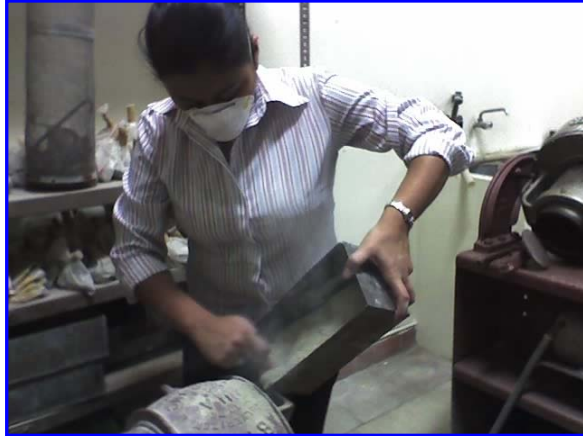
FIGURA [3.11] AGREGANDO MATERIAL AL MOLINO DE DISCOS
