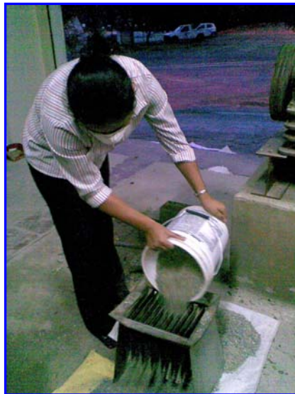
FIGURA [3.8] CUARTEANDO EL MATERIAL
