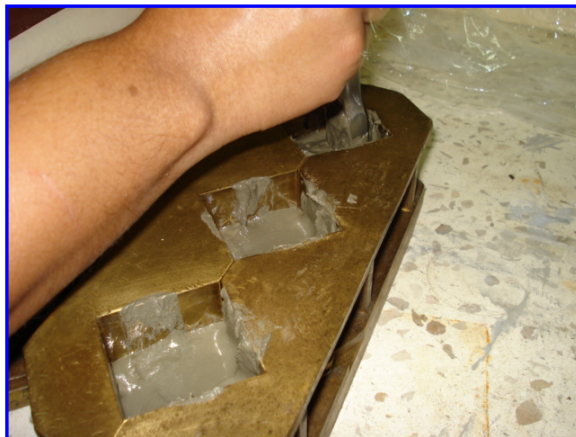
FIGURA [3.23] LLENANDO LOS MOLDES CON PASTA
