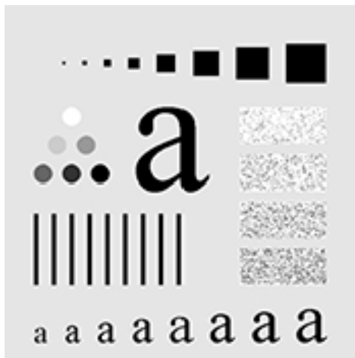
Figura 3.18 Patrón de Prueba escalado por Interpolación Bilineal
