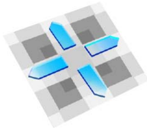
Figura 2.8 Interpolación Bilineal. Crea un nuevo pixel basado en los vecinos horizontales y verticales del área ya hecha padding.
