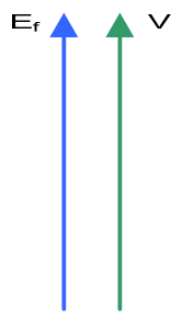
Fig. 1-7. Diagrama vectorial en condición de vacío.
