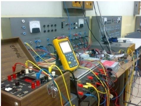
**Fig. 11** Conexión física del DVR para compensar sag y swell
