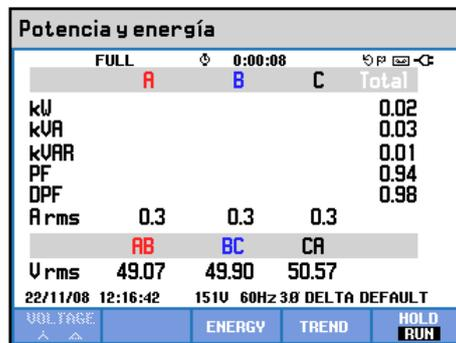
Fig. 17 Potencia y energía durante la compensación del voltaje sag
