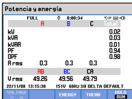
Fig. 25 Potencia y energía durante la compensación del voltaje swell
