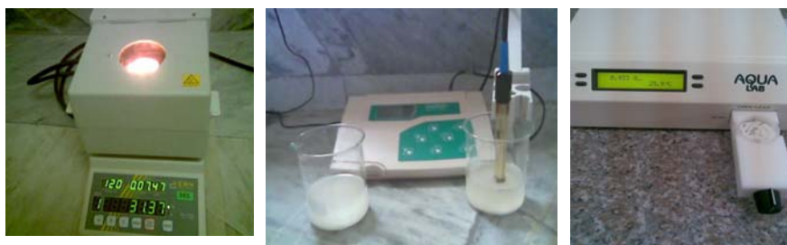
Fig. 2.1 Equipos utilizados para medir pH y humedad
