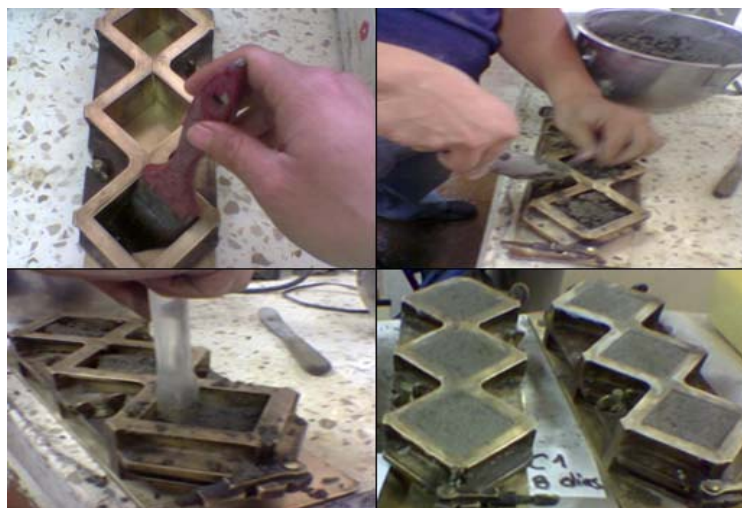
Fig. 4.16 Moldeo de morteros
