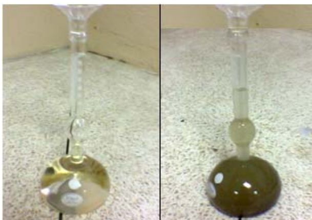
Fig. 4.6 Prueba de densidad matraz Le Chatelier
