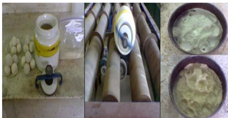
Fig. 4.10 Tratamiento de Amorfización por molienda
