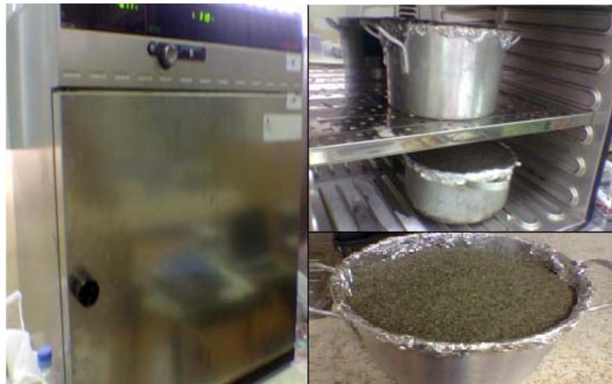
Fig.4.14 Secado de Arena
