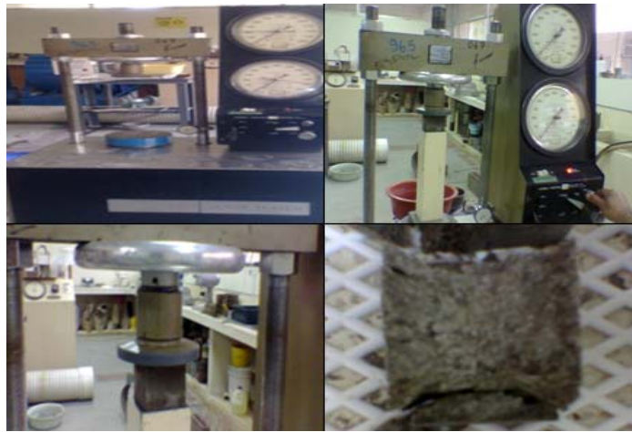
Fig. 4.18 Ruptura de cubos a los 7, 28 días
