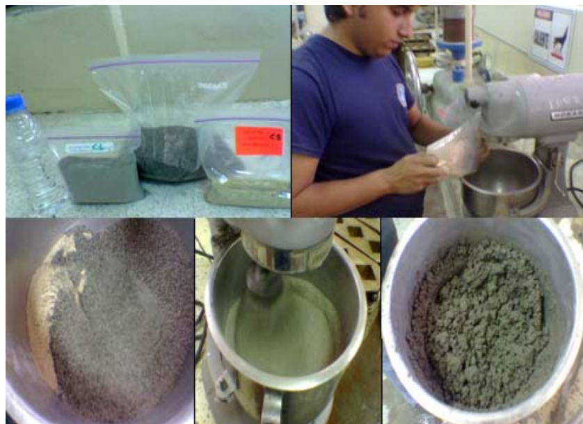
Fig. 4.15 Mezclado de morteros
