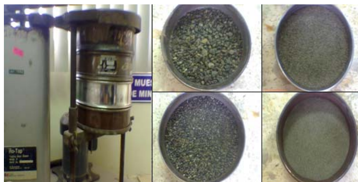
Fig. 4.12 Tamizado de Arena
