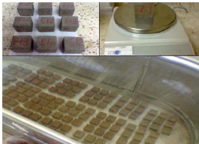
Fig. 4.17 Numeración, pesaje y curado de morteros
