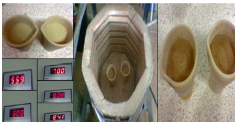
Fig. 4.11 Tratamiento de Calcinación a diferentes temperaturas
