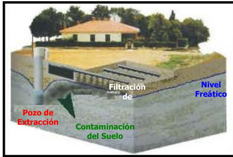
**Figura 1.4** Gráfico general de contaminación de un pozo de extracción de aguas subterráneas por efecto de una fosa séptica, <http://www.miliarium.com>.
