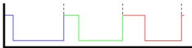
Figura 2.10 PWM para recorrer todo el rango de operación del servo
