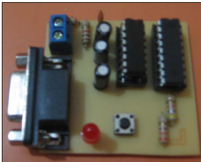
Figura 2.3.6. Parte superior de la baquelita del circuito de control
