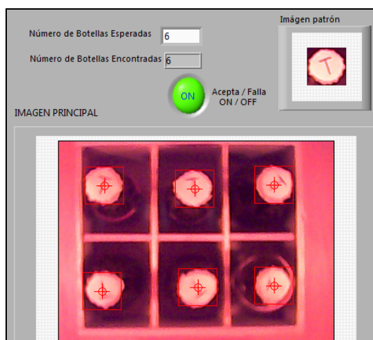
Figura 3.2.2.13. Panel frontal de una caja aceptada
