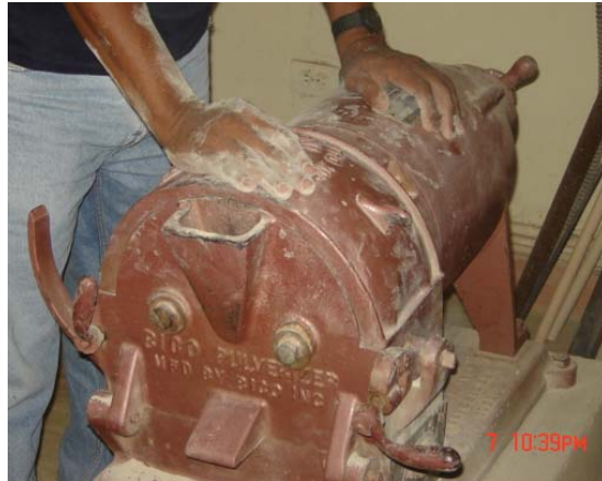
FIGURA 3.13. MOLINO DE DISCOS
