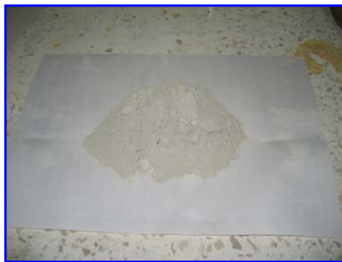
FIGURA 3.16. ZEOLITA CON GRANULOMETRÍA FINAL 45 \mu m
