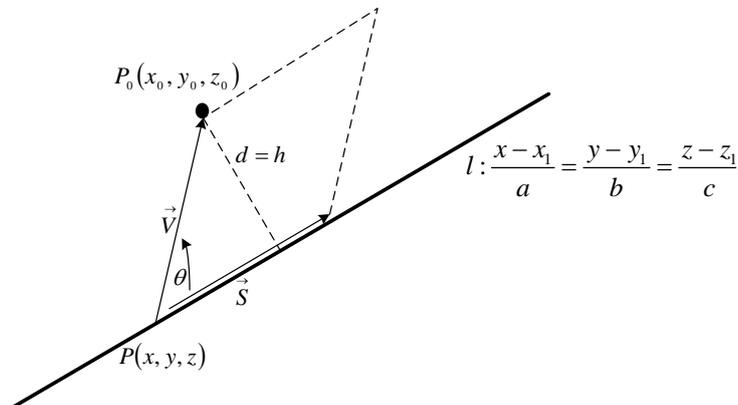
La distancia entre el punto  $P_0$  y la recta  $l$ , será la altura del paralelogramo sustentado por los vectores  $\vec{V}$  y  $\vec{S}$ . Observe la figura anterior.
