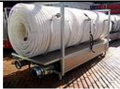
Icebox con colectores abajo y el suelo frigorífico enrollado encima
