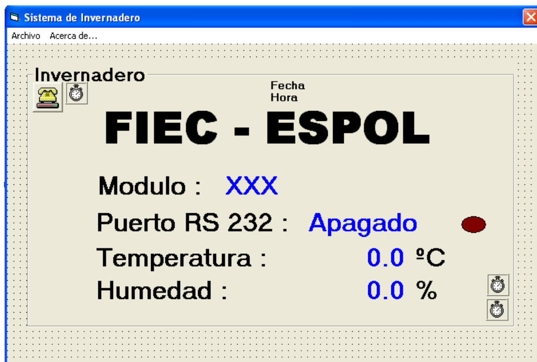
Figura 24 Pantalla de monitoreo humedad y temperatura
