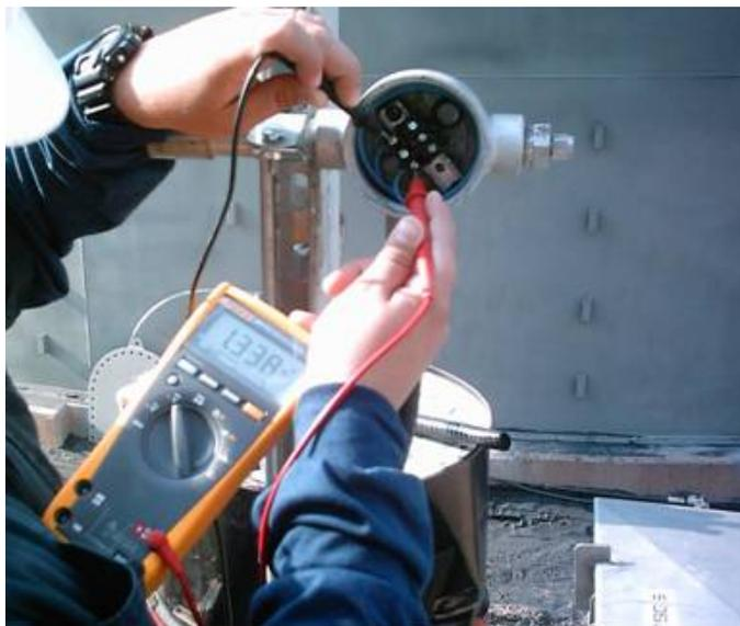
FIGURA 3.6 MEDICION DEL POTENCIAL DE POLARIZACION
