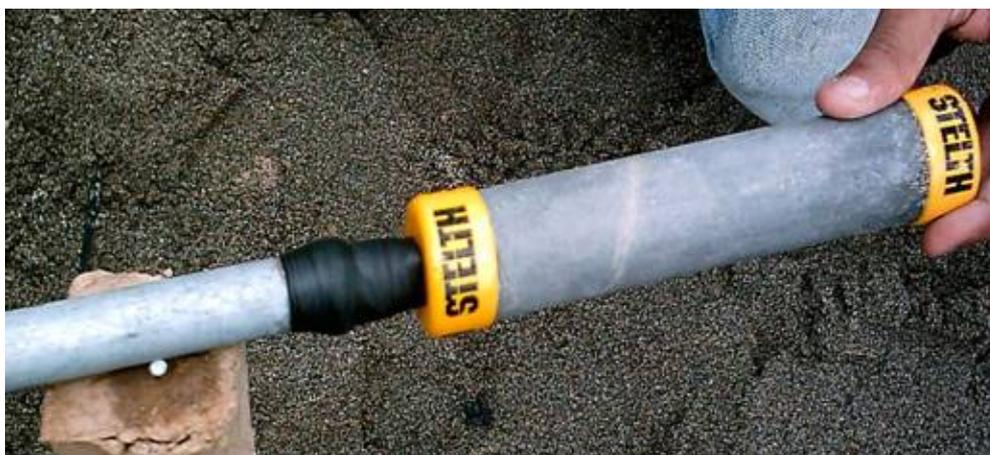
FIGURA 3.1 ELECTRODO DE REFERENCIA PERMANENTE  $\text{Cu}/\text{CuSO}_4$
