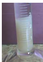
FIGURA 4.7 CAPACIDAD DE HINCHAMIENTO EN PROBETA EFECTO DE LA SAL DE CITRATO A PH ÁCIDO SOBRE LA PECTINA. FUENTE ORIGINAL
