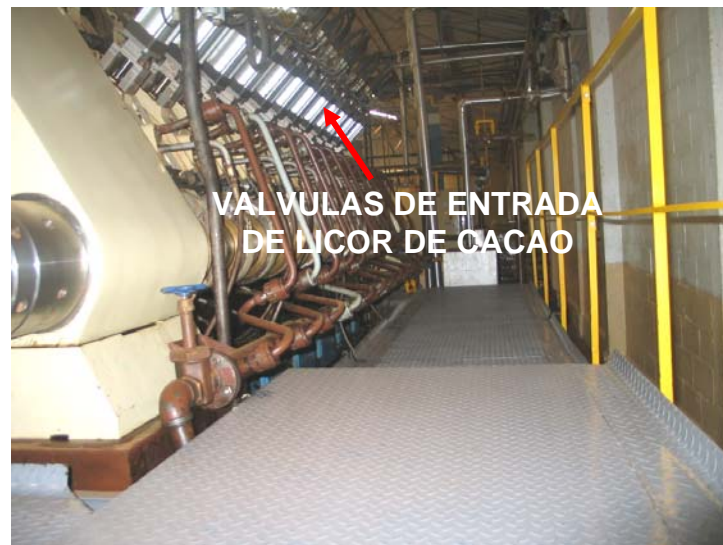
FIGURA 4.9. VISTA DE PRENSA Y SUS VALVULAS
