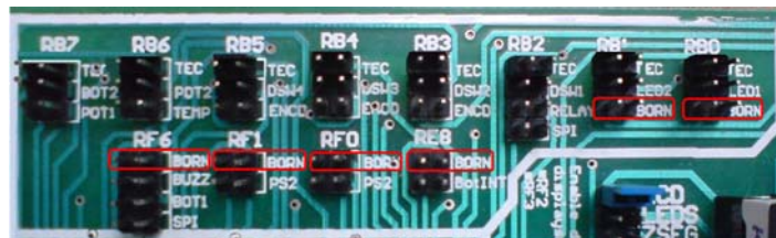
Figura 04.40. Habilitadores de salida por bornera
