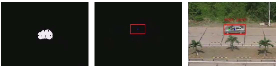
Figura 14 Izq. Imagen resultante de la segmentación; Centro. Imagen resultante de la caja englobante; Der. Imagen resultante del filtro de predicción
