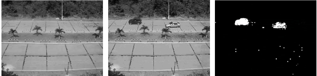
Figura 6 (izquierda) Escena original sin objetos en movimiento (imagen de fondo o background), (centro) escena con vehículos en movimiento, (derecha) imagen resultantes con la detección de los objetos en movimiento (imagen de movimiento o foreground).
