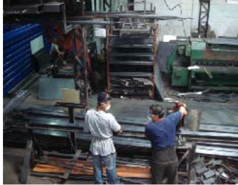
FIGURA 3.4 OPERACIONES DE CORTES DE CORREAS
