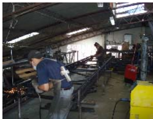
FIGURA 3.7 OPERACIÓN DE ENSAMBLE DE MARCOS
