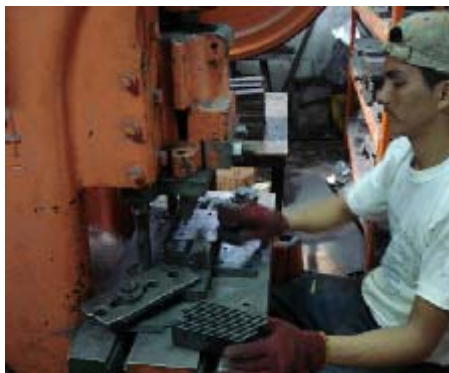
FIGURA 3.13 OPERACIÓN DE TROQUELADO Y REMACHE DE PINES
