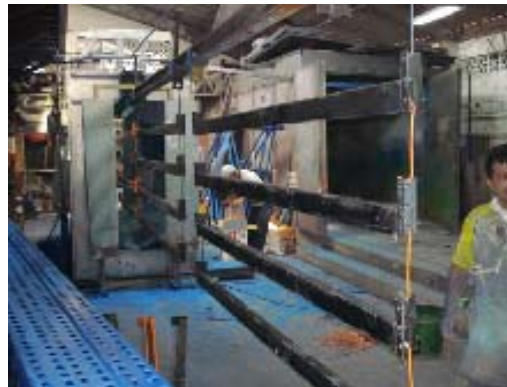
FIGURA 3.18 OPERACIÓN ROCIADO DE PINTURA A VIGAS
