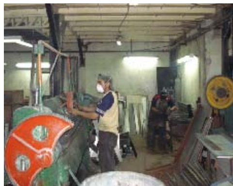
FIGURA 3.5 OPERACIÓN DE DOBLADO DE TEMPLADORES
