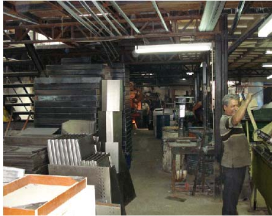
FIGURA 3.22 ACUMULACIÓN DE MATERIAL EN PASILLO DE ACCESO A ÁREAS DE TRABAJO
