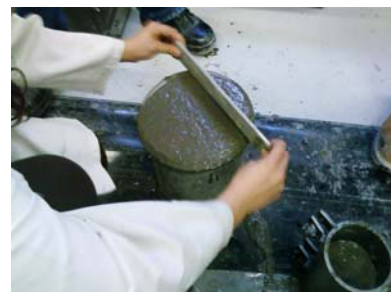
Figura # 3.1 Ensayo para determinar la Densidad
