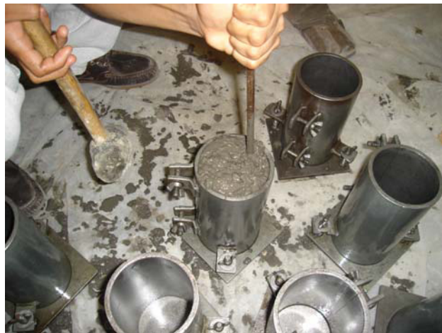
Figura # 6. 13 Elaboración de cilindros
