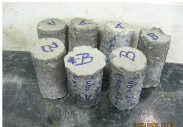
Figura # 6. 15 Calado de núcleos y cilindros calados
