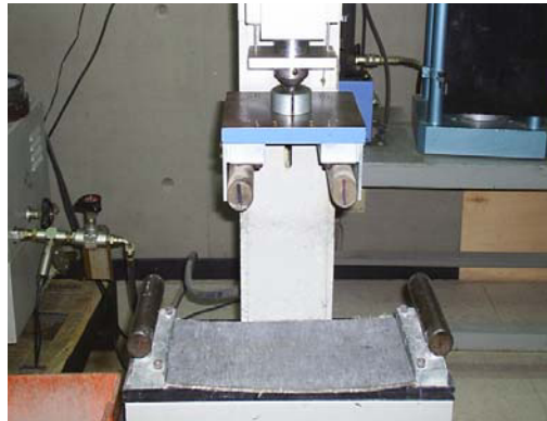
Figura # 4.3 Equipo utilizado prensa “ELE” 3000 kN.
