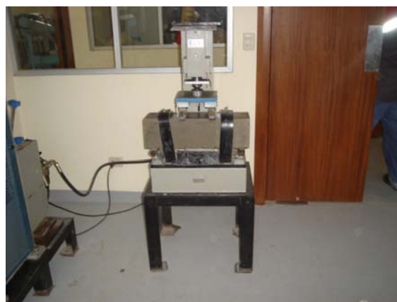
Figura # 4.4 Ensayo Resistencia a la Flexión
