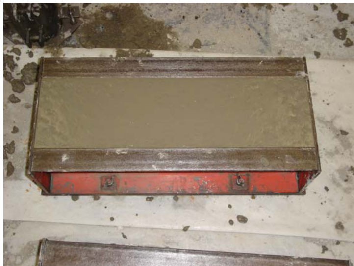
Figura# 6. 14 Elaboración de vigas
