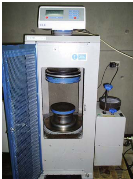
Figura # 4.1 Prensa "ELE" 2000 kN.
