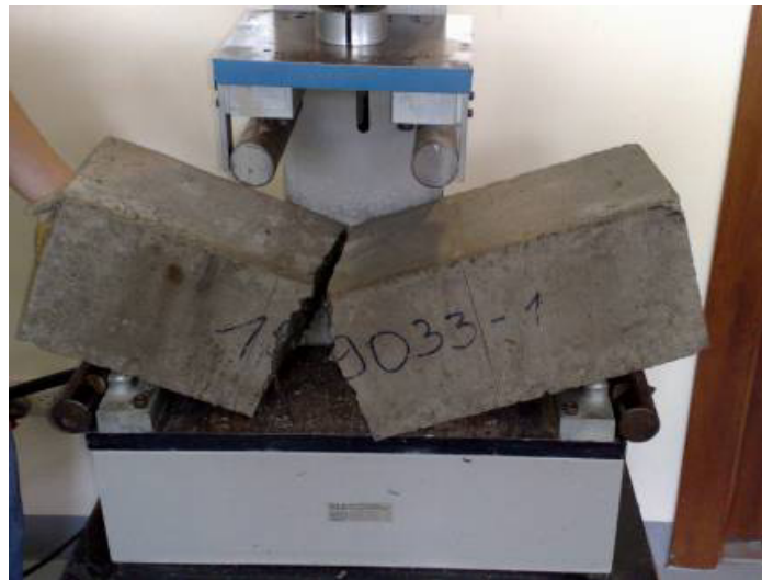
Figura # 4.5 Viga ensayada a flexión
