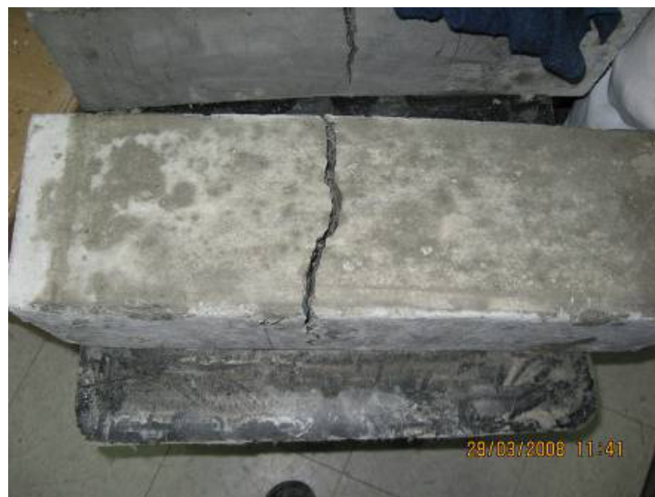
Figura # 4.6 Aspecto de la viga de ensayada a flexión
