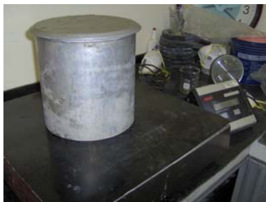
Figura # 3.1 Ensayo para determinar la Densidad
