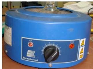
6. Observar el proceso por un periodo de 1  $\frac{1}{2}$  horas en promedio hasta que casi todo el éter se haya evaporado, se calcula necesario de 6 a 10 sifonadas para obtener aceite con una reducida cantidad de éter.
