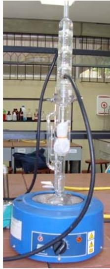
5. Encender la estufa, regulándola hasta 70°C de temperatura (temperaturas superiores implicarían evaporación excesiva de éter durante el proceso).
