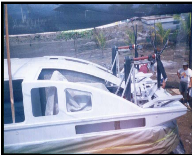
Foto 3.6.- Ensamble de transmisión
