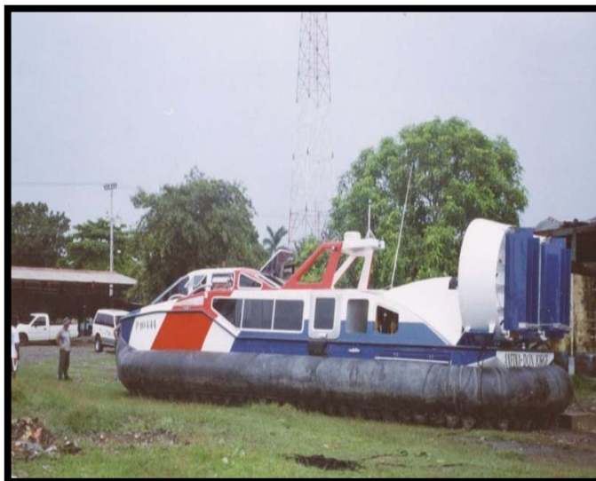
Foto 4.1.- Pruebas de acoplamiento del Sistema de Sustentación
