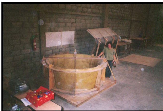
Foto 2.11.- Modelo de la Tobera de la hélice en poliuretano
