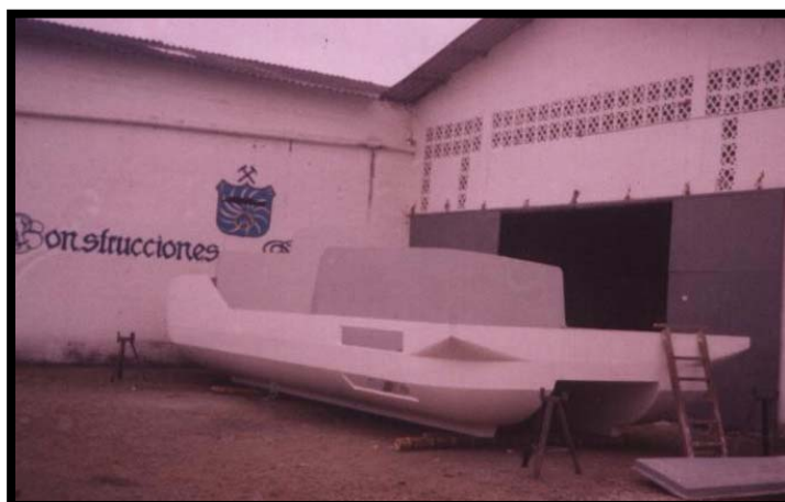
Foto 2.28.- Desmolde de casco junto con mamparos
