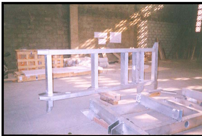
Foto 2.36.- Construcción de bases de motores de impulsión con soldadura MIG
