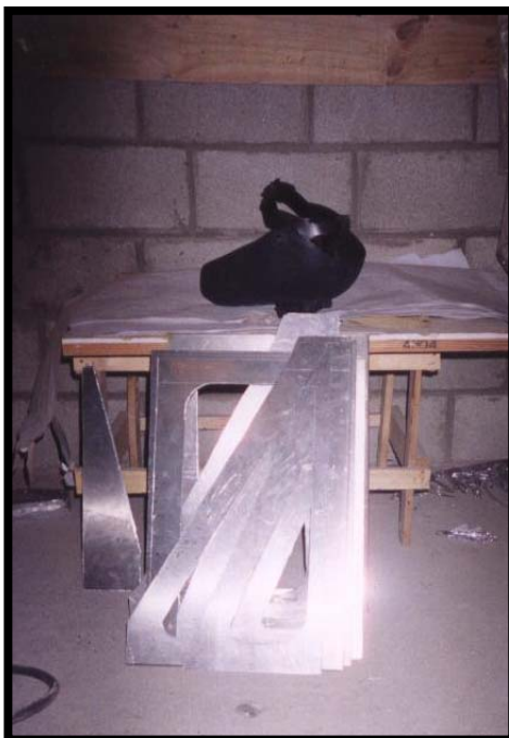
Foto 2.35.- Corte con plasma de elementos para base de motores de sustentación
