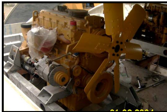
Foto 2.41.- Montaje de motores de impulsión
