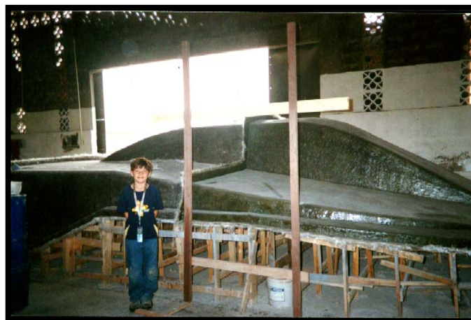
Foto 2.21.- Molde de Superestructura
