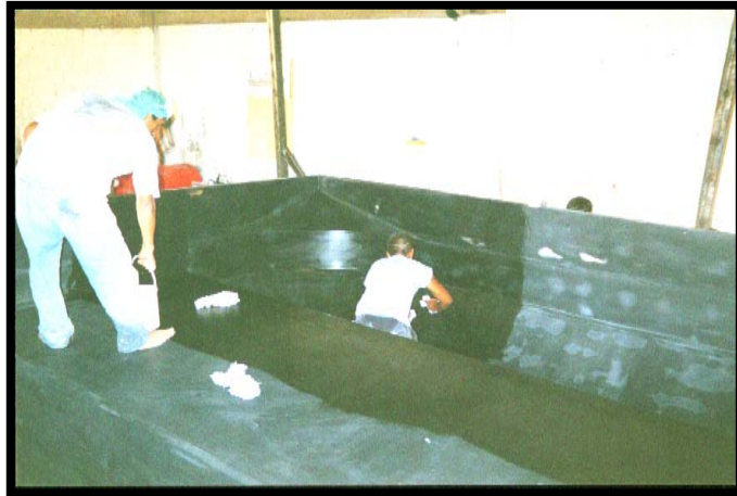
Foto 2.25.- Abrillantado de Molde
