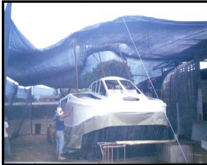
Foto 3.8.- Proceso de masillado
