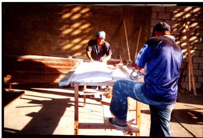
Foto 2.12.- Construcción de Modelo de timones
