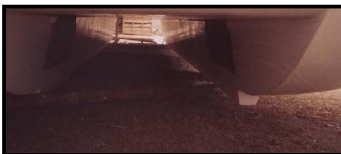
Foto 2.30.- Sector inferior de casco, ductos de aire
