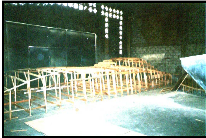
Foto 2.8.- Modelo de superestructura en cuadernas
