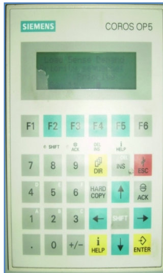
Figura A33. Panel de operación Siemens “COROS OP5”
