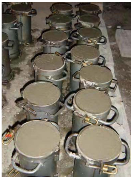
Fotografía 4.2.- Cilindros de hormigón para ensayo de compresión.
