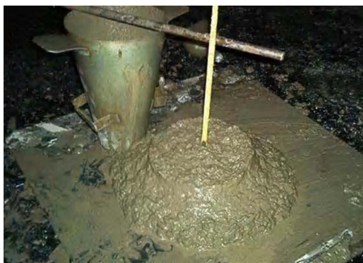
Fotografía 4.1.- Medición de Revenimiento, ensayo con el cono de Abrahms.
