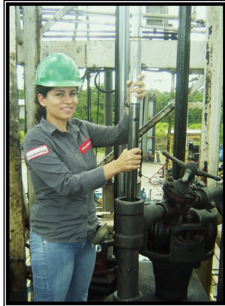
FIGURA 2.22. LANZAMIENTO DEL FAST GAUGE DESDE SUPERFICIE
