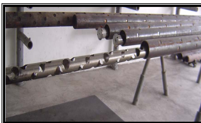
FIGURA 2.11. CAÑONES Y REGLETAS PORTA CARGAS (FUENTE: HALLIBURTON)
