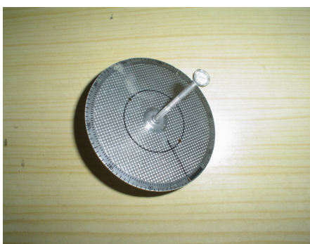
Fig. 29: Disco de Giro de un Medidor Electromecánico
