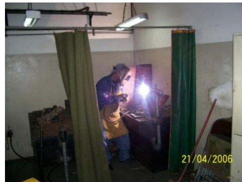
Figura. 3.4 Fotografía del operador soldando en posición 3G.
