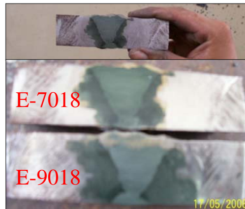
Figura. 3.8 Probetas para macroscopia.
