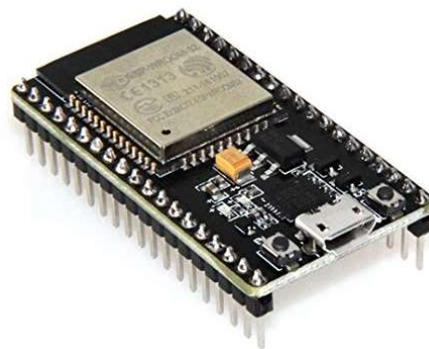
**Figura 1.0.7.-** Microcontrolador ESP32.
