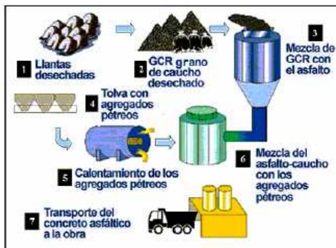
**Figura 2.9.** Esquema de fabricación de mezcla asfáltica con caucho por vía húmeda
