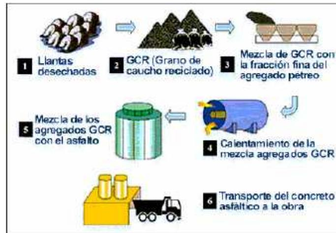
**Figura 2.8.** Esquema de fabricación de mezcla asfáltica con caucho por vía seca
