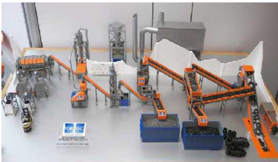
**Figura 3.5.** Diagrama general de la línea de producción
