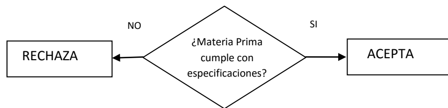
FIGURA 2.4 SÍMBOLO CONDICIONAL EN EL DIAGRAMA DE FLUJO DE PROCESO-EJEMPLO.
