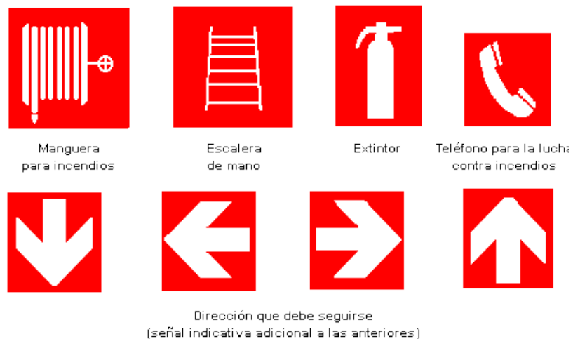
FIGURA 4.10 SEÑALES DE EMERGENCIA E INFORMACIÓN
