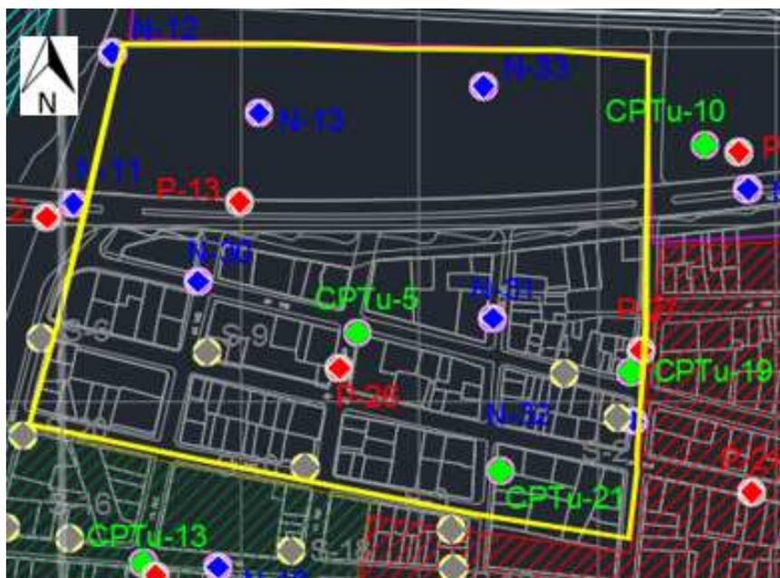
**Figura 5.10** Se muestra la unidad sísmológica 3, con los ensayos que se incluyen para el análisis de licuación.
