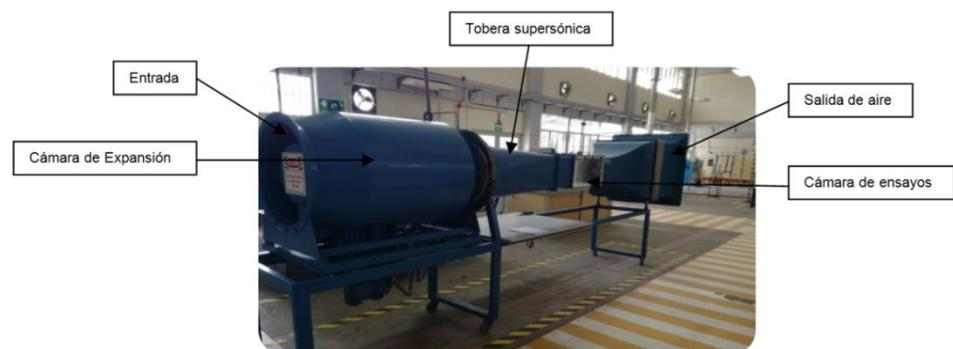
**Figura 1. 7 Túnel Supersónico de Viento**
