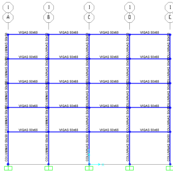
Figura 5.15 Dimensiones de secciones estructurales Fuente: Software SAP 2000
