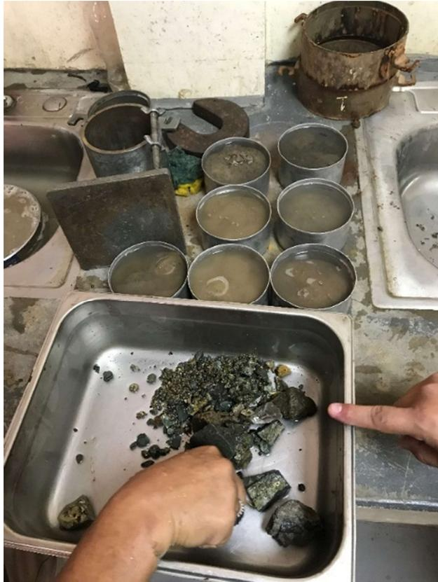
**Figura 3.12** Lavado del material tamizado.
