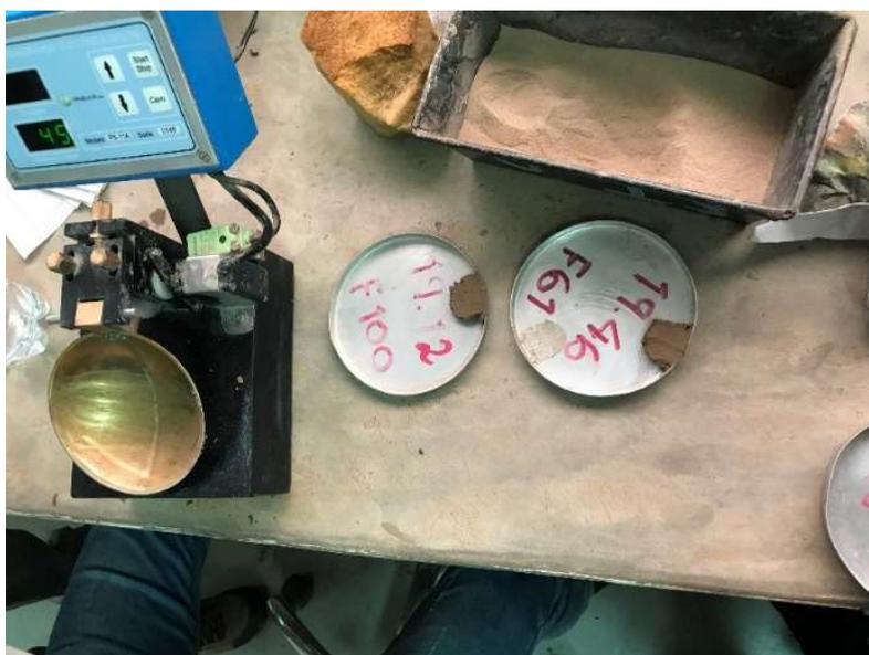
**Figura 3.9** Colocación en tara para secado y posterior pesaje.
