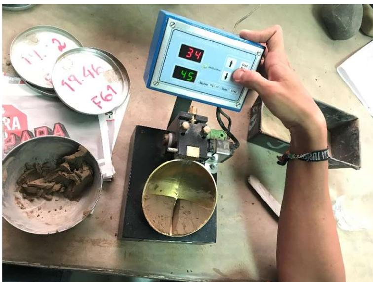
**Figura 3.8** Realización del ensayo de limite líquido.
