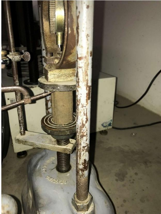
**Figura 3.13** Ensayo de compresión simple.
