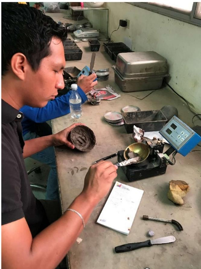
**Figura 3.7** Colocación de la muestra a ensayar.
