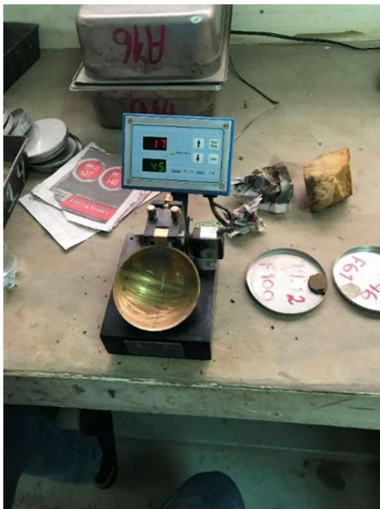
**Figura 3.6** Cuchara de Casagrande para límite líquido.
