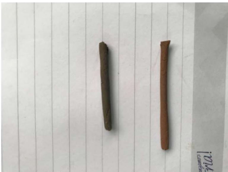
**Figura 3.10** Cilindros de 3 mm de material a ensayar.
