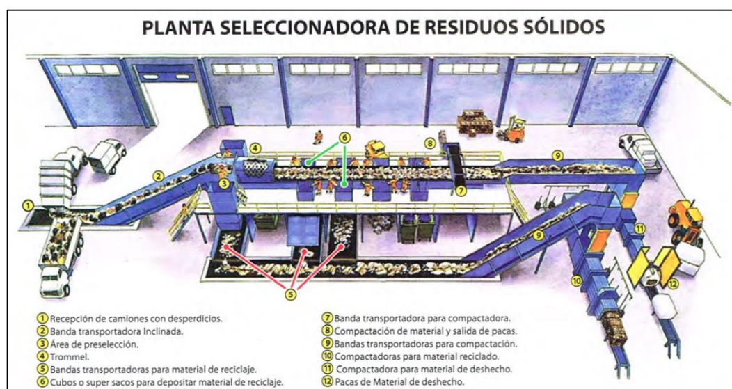
Figura 7.3 Esquema de la planta de reciclaje Fuente: COPARM, 2018.
