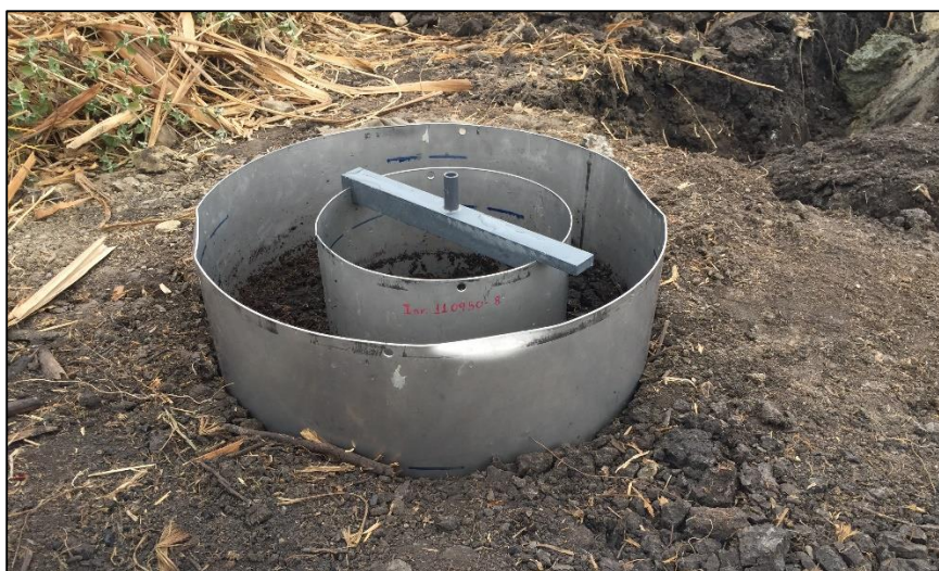
Figura 5.13 Ensayo de permeabilidad in situ
