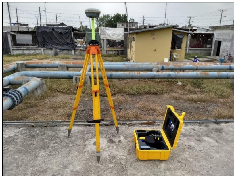
Figura 5.1 Equipo GNSS Fuente: Rodriguez, O., Condoy, A., 2017.
