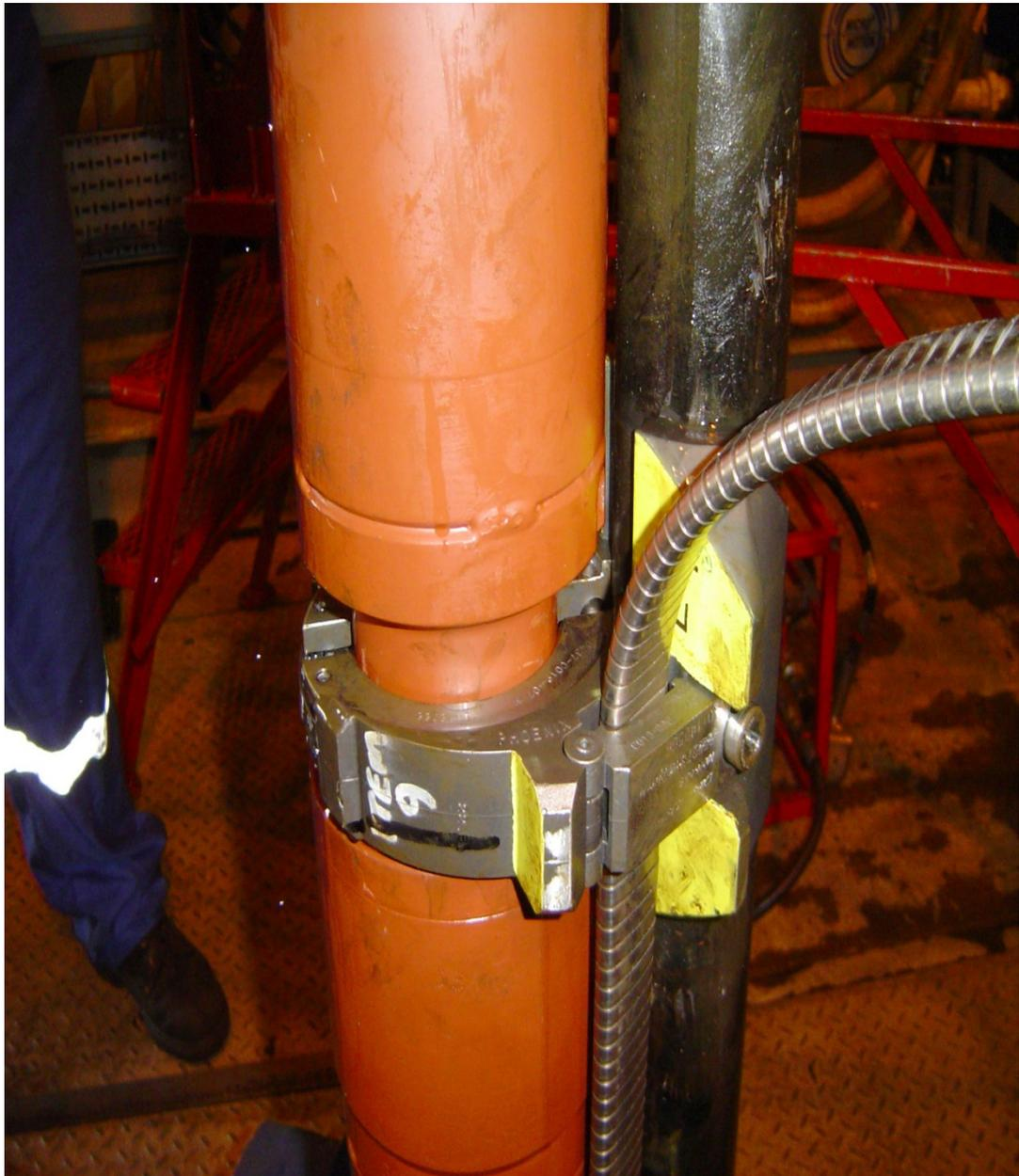
**Fig. 29 Fotografía es tomada al momento de bajar el Clamp acoplado al By-pass tubing; a la bomba, y al cable eléctrico.**
