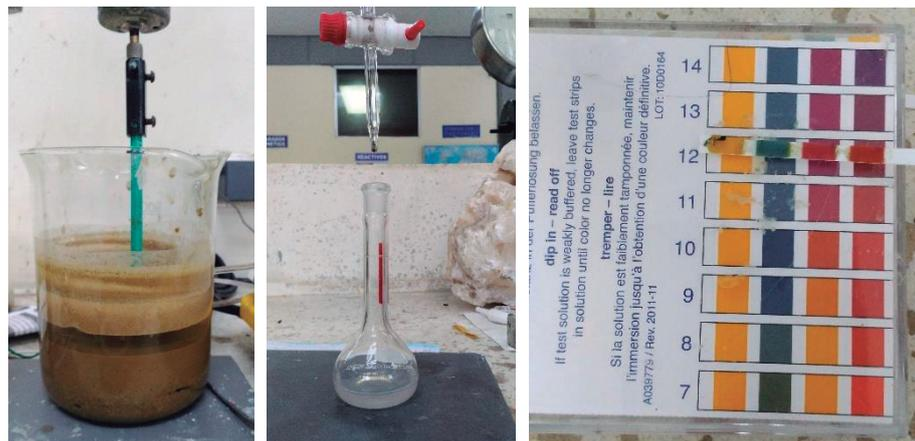
**Figura 3. 15:** Cianuración, titulación del CN<sup>-</sup> libre y control de pH
